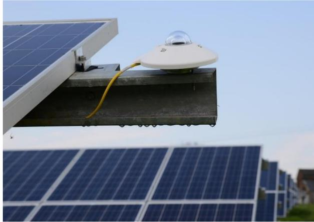
**Figure II.5-** Utilisation d'un pyranomètre dans une station photovoltaïque
