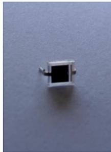
Figure IV.6- La photodiode BPW34.
