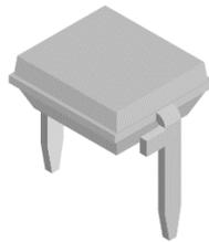
Figure III.2- Photodiode BPW34
