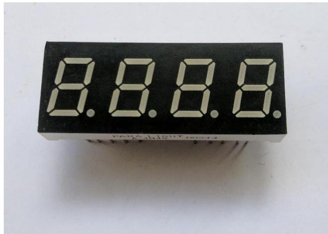
Figure IV.9- Afficheur sept segment de quatre digits.
