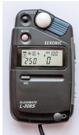
Figure II.8- Posemètre flashmètre SEKONIC
