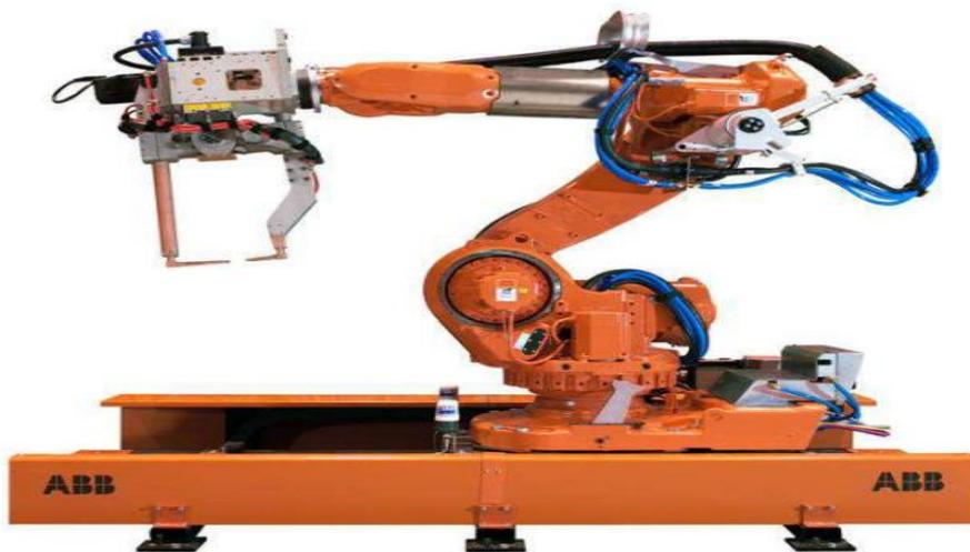
**Fig.1.13 :** Bras soudeur d'ABB
