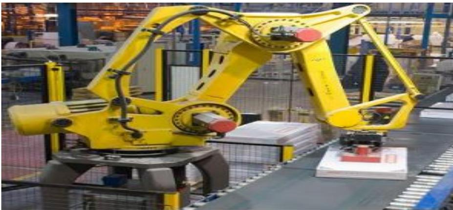
**Figure 1.9 :** Robot sériel pour palettisation à quatre ddl
