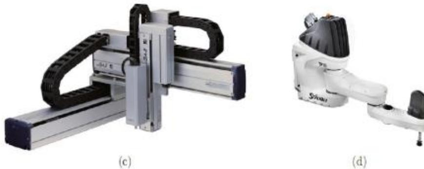
**Figure 1.11 :** (c) est un robot cartésien, (d) est un robot SCARA
