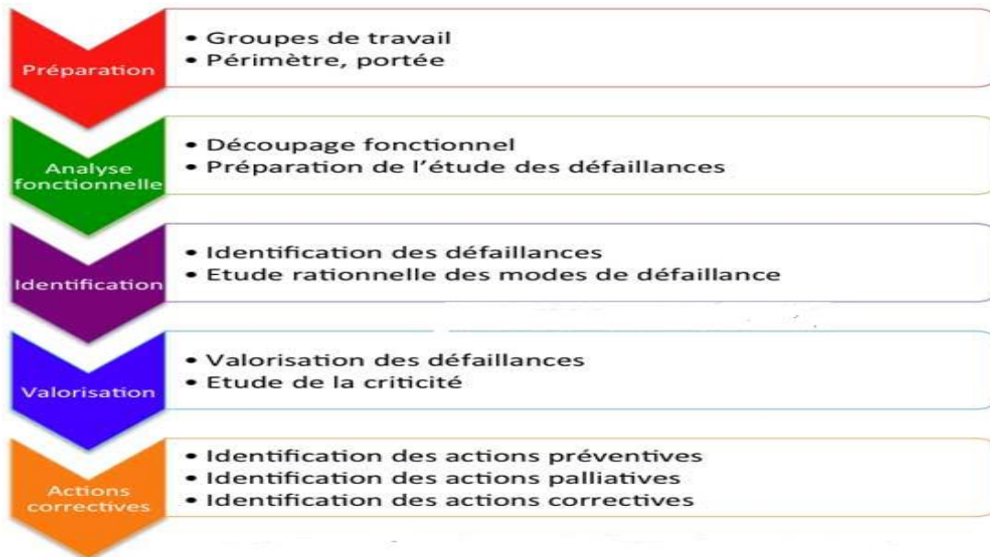
Figure 2.3 : Analyse AMDEC, Schéma de principe [16]
