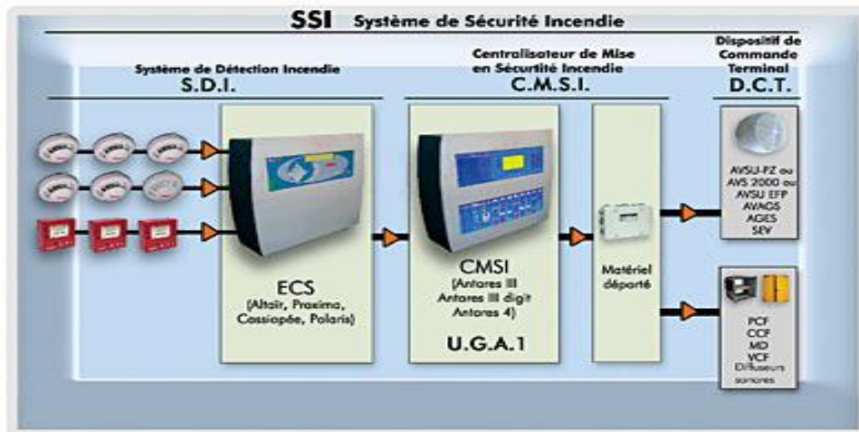
Figure 2-8 : Principe du Système de Sécurité Incendie
