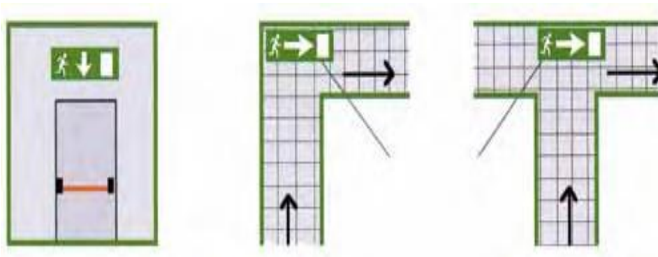
Figure 4-3 : Eclairage de sécurité
