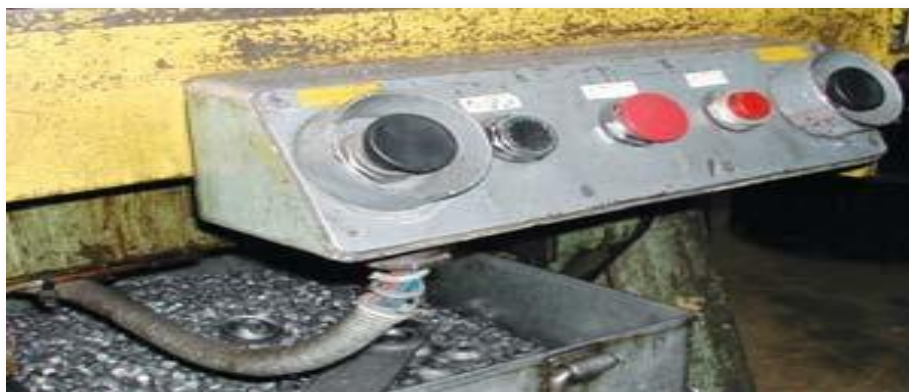
Figure V.6 Diapositive de commande bi-manuel les boutons sont protégés par des collerettes
