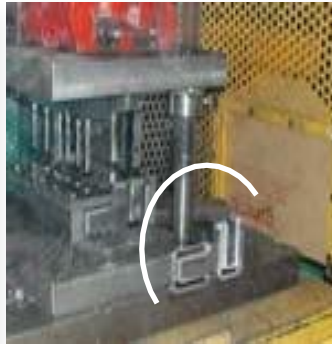
Figure V.2 Protecteur muni d'ouverture pour insérer des pièces
