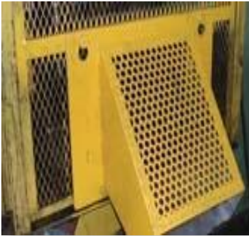
Figure V.1 Protecteur muni d'une ouverture pour la sortie des pièces
