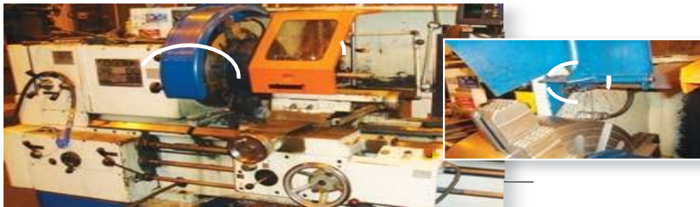
Figure V.4 Un dispositif de protection commande l'arrêt de la machine dès l'ouverture de protecteur
