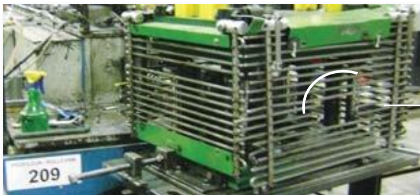
Figure V.5 Protecteur muni d'une tige coulissante qui s'ajuste selon la dimension de la pièce
