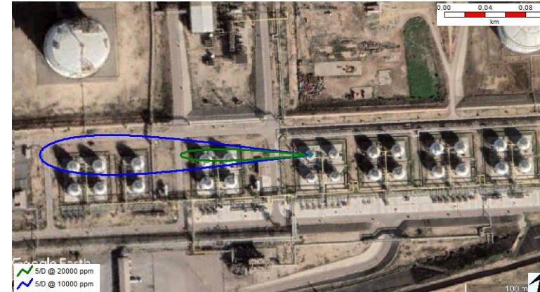
Figure III. 10: Dispersion de nuage de gaz direction du vent vers l'ouest (petite fuite)
