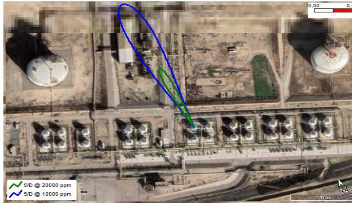
Figure III. 9: Dispersion de nuage de gaz direction du vent vers le nord (petite fuite)
