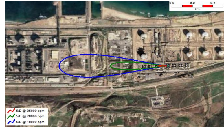
Figure III. 18: Dispersion de nuage de gaz direction du vent vers l'ouest ( grande fuite)
