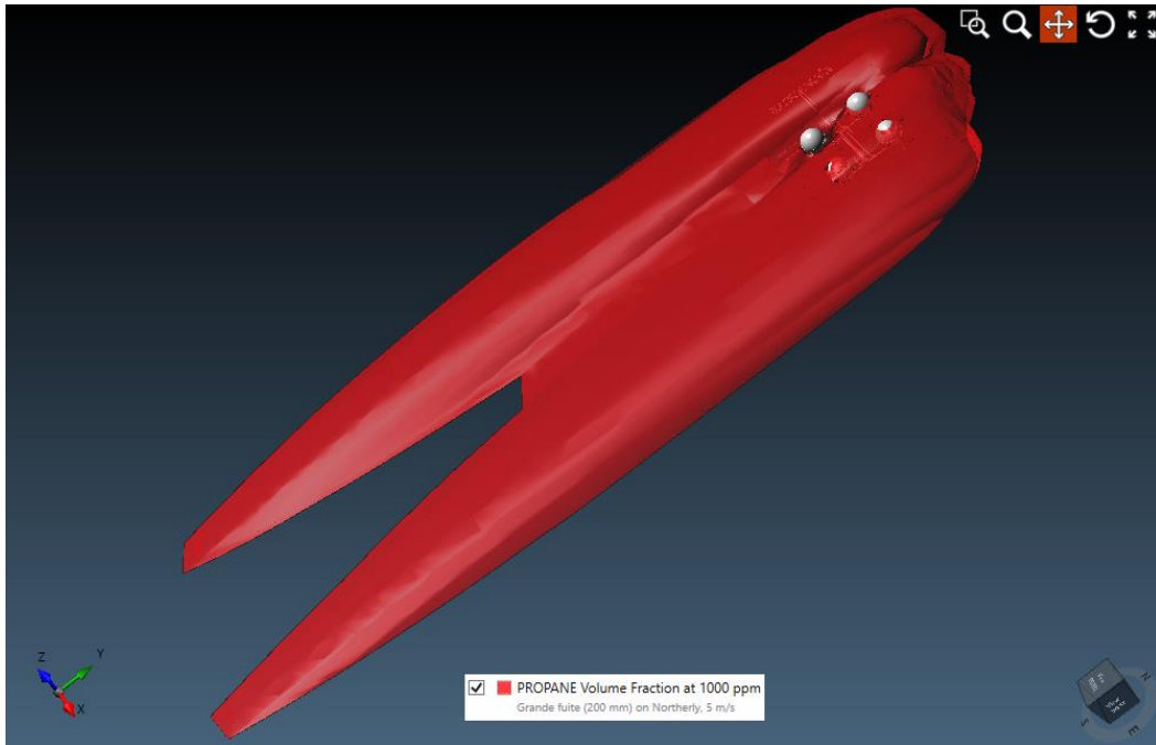
Figure III. 43: vue en 3D sur la propagation de nuage de gaz due à une grande fuite vers le Sud * (capture 3D)
