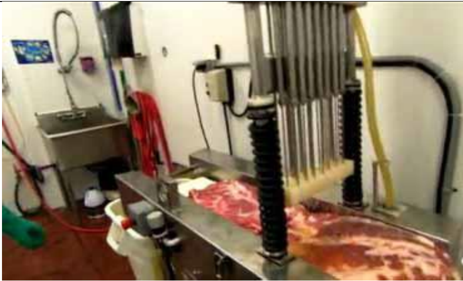
Figure III 3 Injection automatique de la saumure
