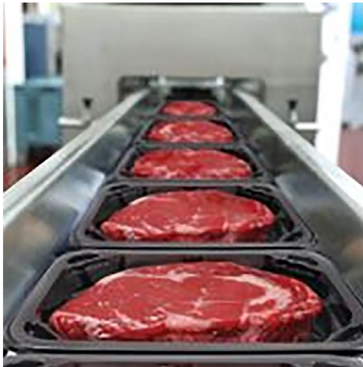
Figure V 3 ligne de conditionnement prête à l'emploi pour steaks en barquettes
