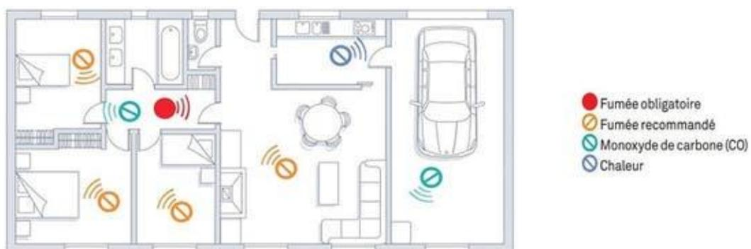
**Figure IV.3. L'emplacement des détecteurs de fumées**
