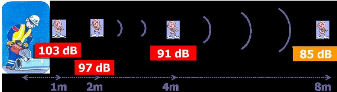
Figure 25 – Réduction de bruit par éloignement
