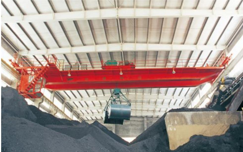
Figure (IV- 6): Pont roulant à benne avec commande en cabine
