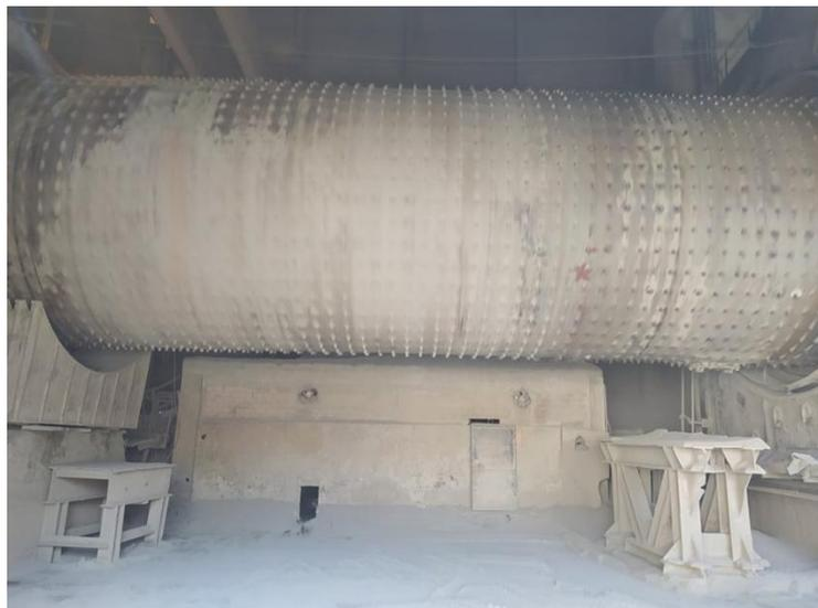
Figure (III-5) : Broyeur du ciment
