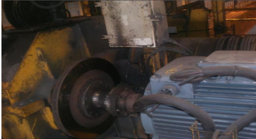
Figure (IV - 10): Frein d'un pont roulant
