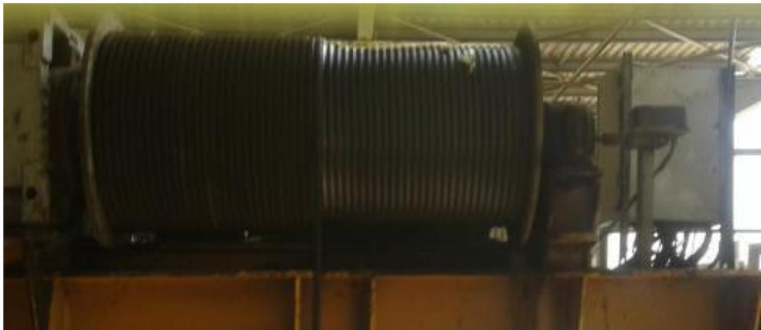
Figure (IV- 9): Tambour d'un pont roulant
