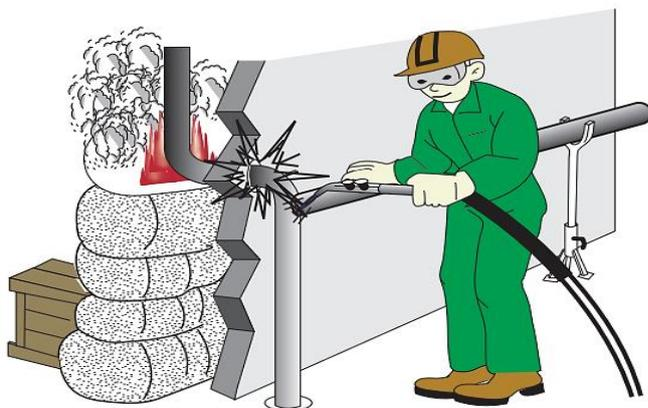
Figure 1- 9: Soudure sur le toit d'un bac en service qui enflamme la phase vapeur [8]
