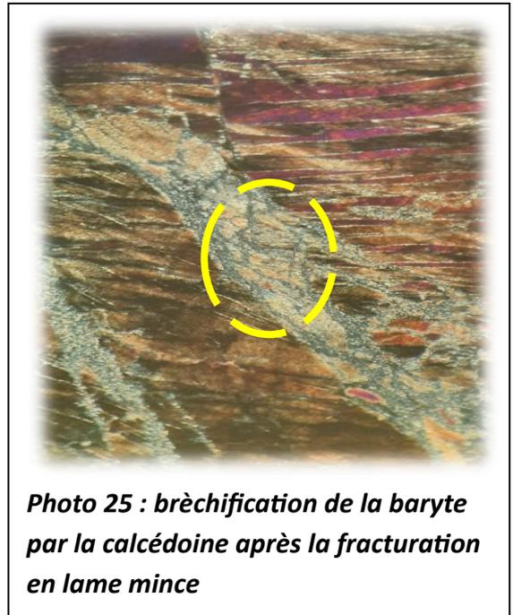
**Photo 25 : brèchification de la barytine par la calcédoine après la fracturation en lame mince**
