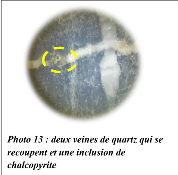
*Photo 13 : deux veines de quartz qui se recourent et une inclusion de chalcopyrite*
