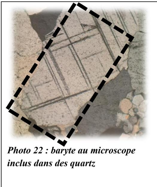
*Photo 22 : baryte au microscope inclus dans des quartz*
