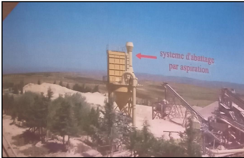
Photo 24.1 : Système d'abattage de poussière par aspiration
