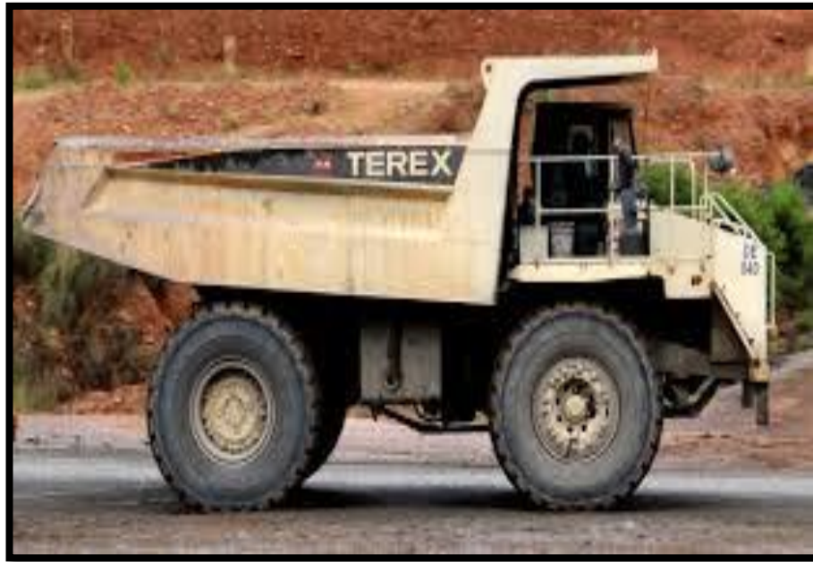
Photo 10.2 : Camion de type TEREX TR 60 en transport vers la station de concassage.
