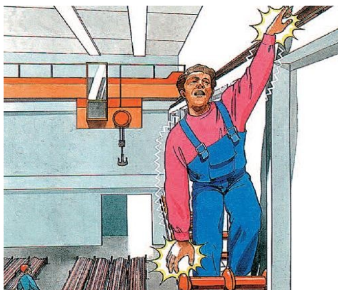
Figure 2.9 : Electrocutation par ligne de contact alimentant un pont roulant
