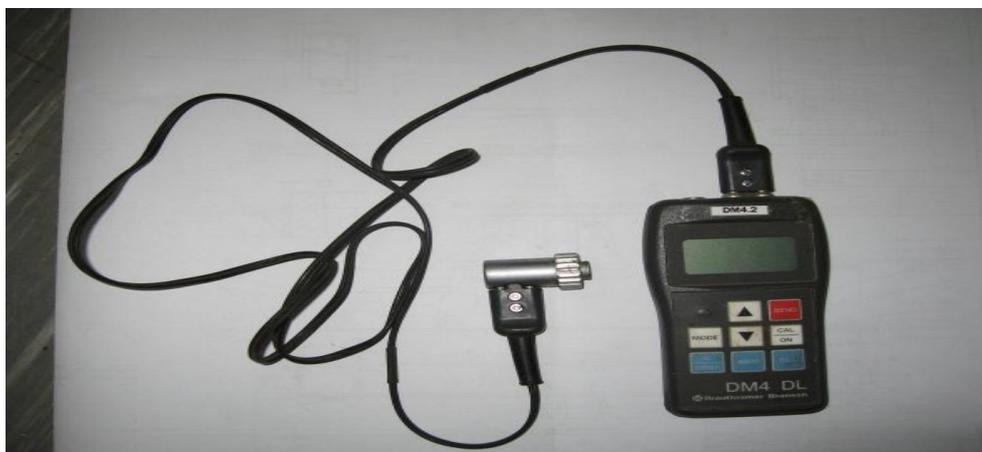
**Figure III.08 :** Appareil DM4 avec palpeur pour la prise d'épaisseur à l'ultrason.
