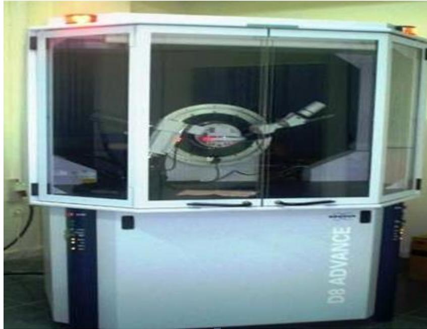
**Figure III.07:** Diffractomètre de rayons X.
