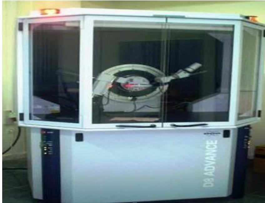
**Figure III.07:** Diffractomètre de rayons X.
