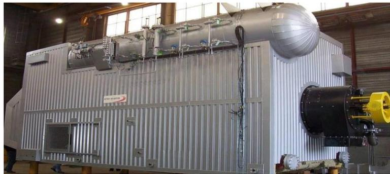
*Figure 10 : Chaudière à tube d'eau*
