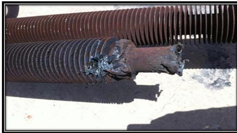
*Figure 42 : Un tube d'économiseur percé*
