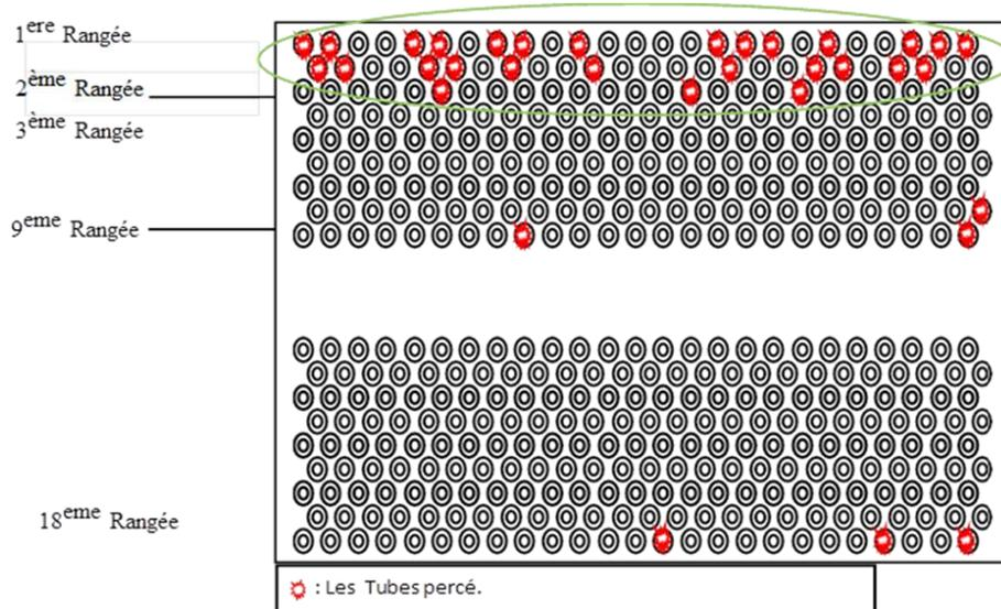
Figure 41 : Situation des tubes percés de l'économiseur de la chaudière 570UA
