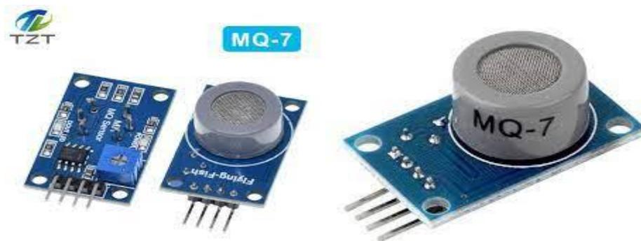
Figure 5 3 : détecteur de monoxyde de carbone MQ7
