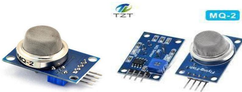
Figure 5 2: capteur de fumée
