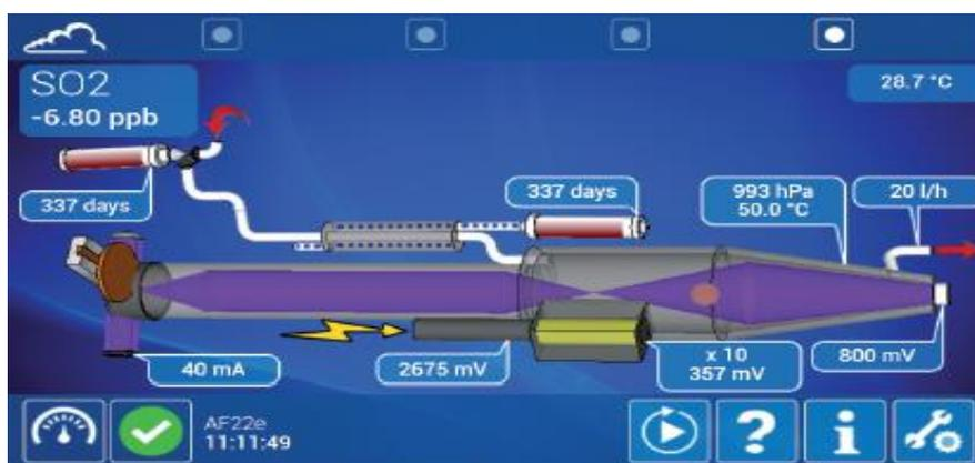
Figure 2 9: principe de fonctionnement d'analyseur ENVEA AF22e
