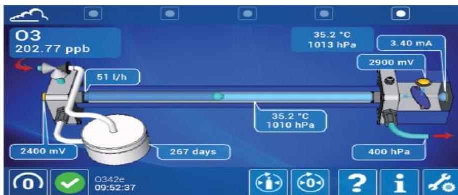
Figure 2 10:le schéma de fonctionnement ENVEA O3 42e
