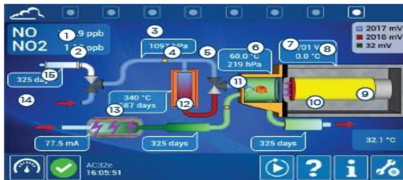
Figure 2 7: principe de fonctionnement d'analyseur ENVEA AC 32e
