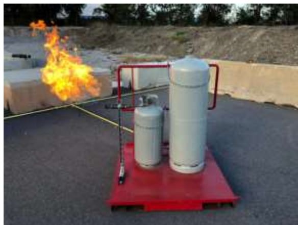
Figure 3.5 : Zone de formation sur incendie propane modèle mobile.
