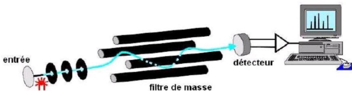
Figure II.2 : Principe d'un spectromètre de masse
