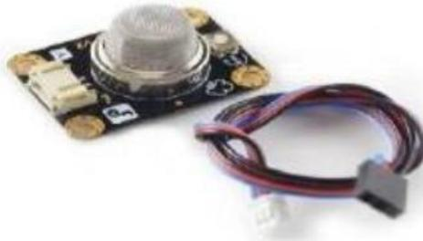
**Figure IV.6 :** Capteur MQ2
