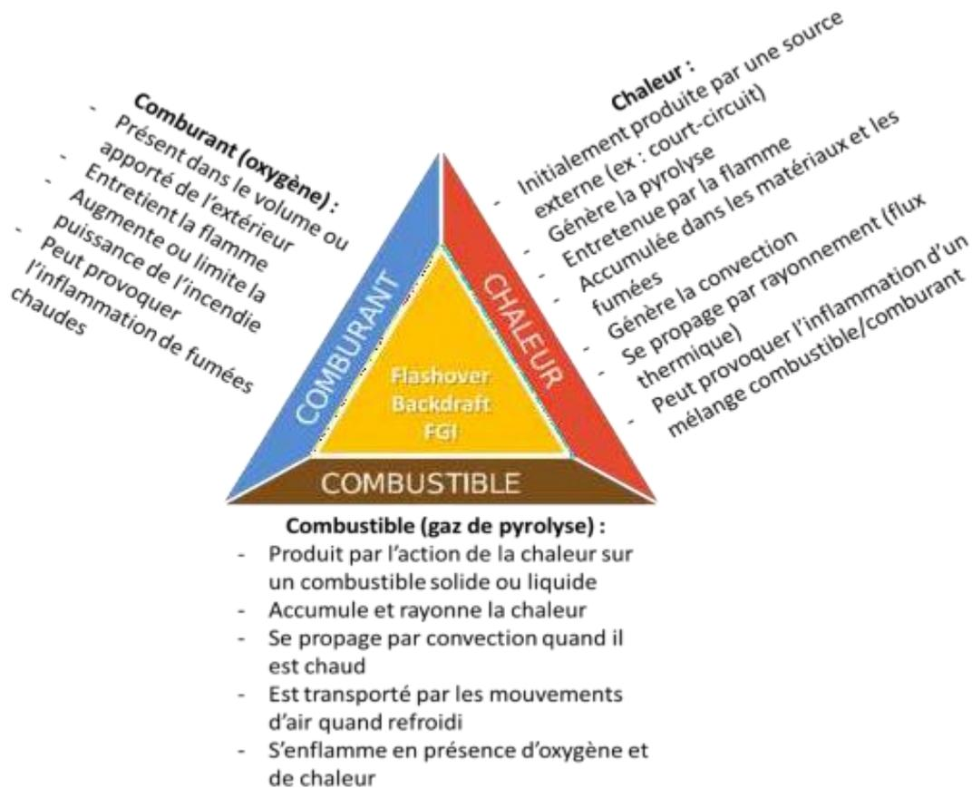
**Figure 2.2 :** synthèse des phénomènes thermiques associés à un développement rapide du feu
