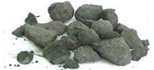
**Figure I.12** - Granulés de clinker prêt à être broyé.
