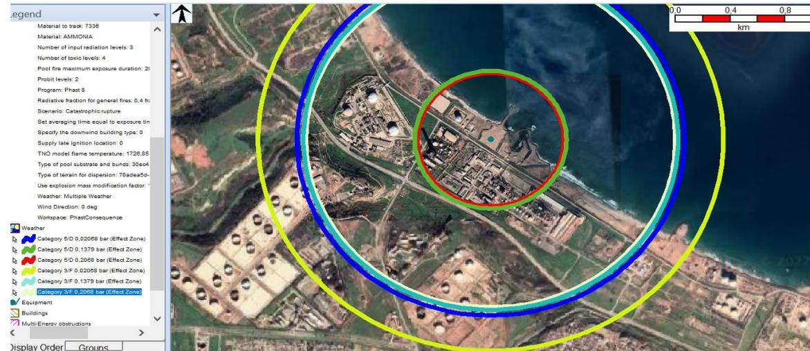
Figure 63 Les seuils des effets d'explosion (UVCE)
