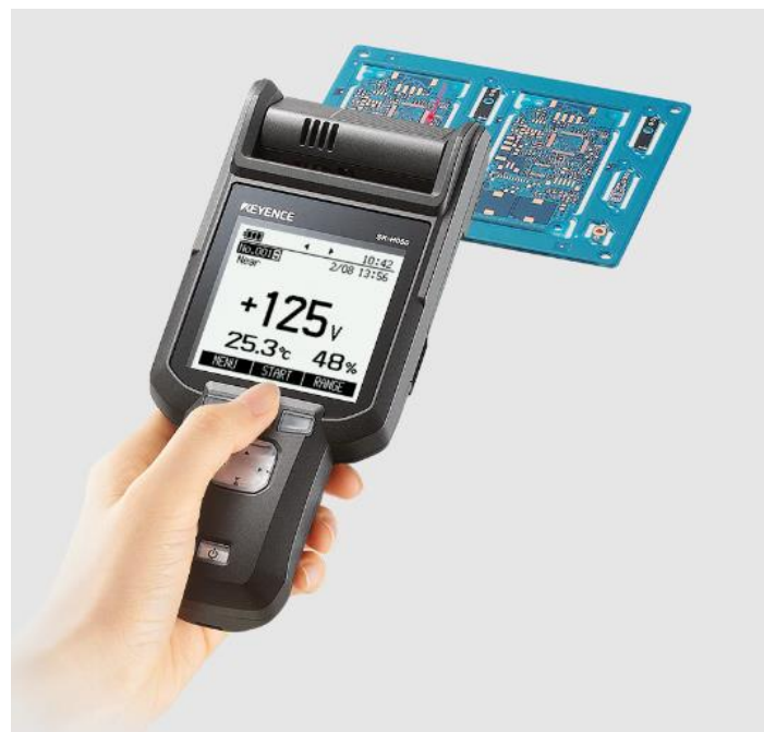
Figure 28 : Mesure de charges statiques avec un capteur.
