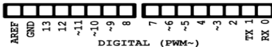
Figure II.17: Entrées et sorties numériques
