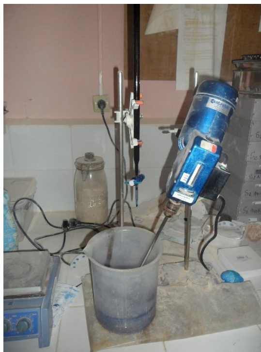
Photo.05 : Essai de bleu méthylène (Labo ENG Sidi Abdelli, 2024).
