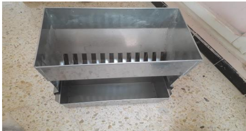
Photo.03 : Échantillonneur pour gravier (Labo. ENG. Sidi abdelli, 2024).
