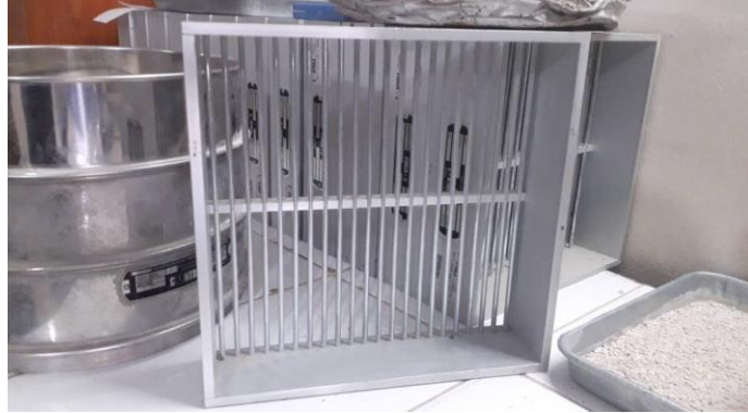
Photo.04 : tamis à fentes (Labo. ENG, Sidi abdelli, 2024)
