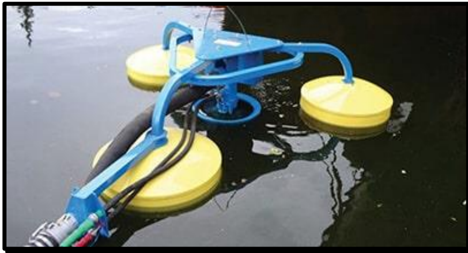
الصورة رقم 19: قاشطة نفط المصدر: موقع ELASTEC
