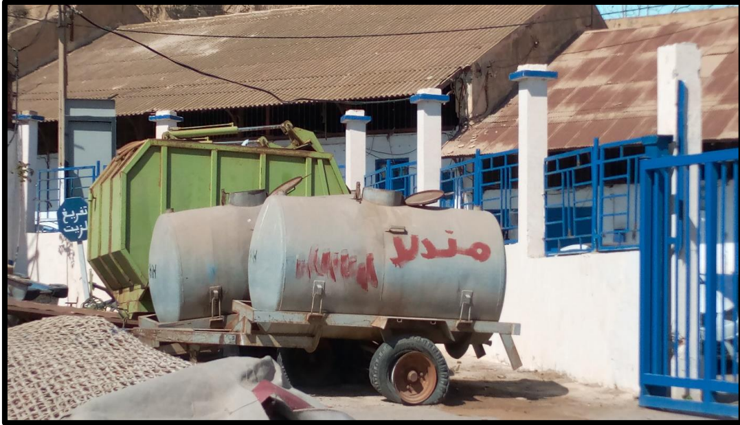
الصورة رقم 29: صهاريج حديدية لرمي زيوت التشحيم المخلفة المصدر: التحقيق الميداني
