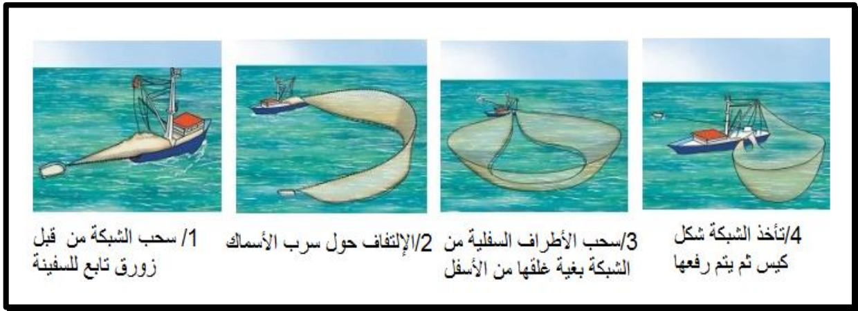
الصورة رقم 09: آلية عمل شبكة الصيد المستطيلة
