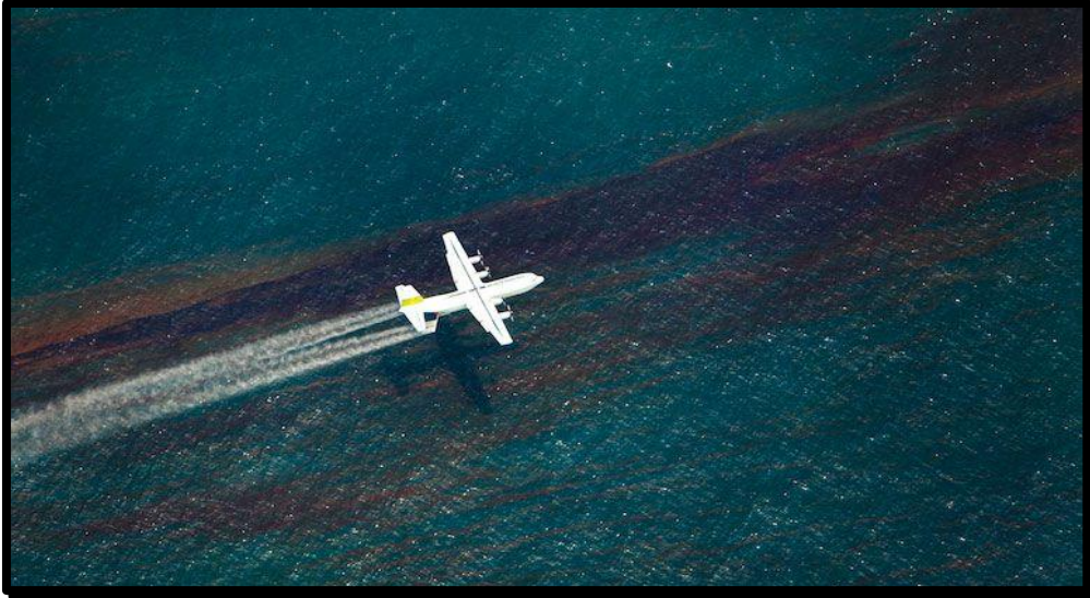
الصورة رقم 21: رش المشتتات على بقعة نفط بواسطة طائرة/المصدر: موقع Encyclopedia of Puget
