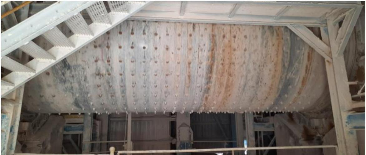
**Figure III-9 :** *Broyeur horizontal.*
