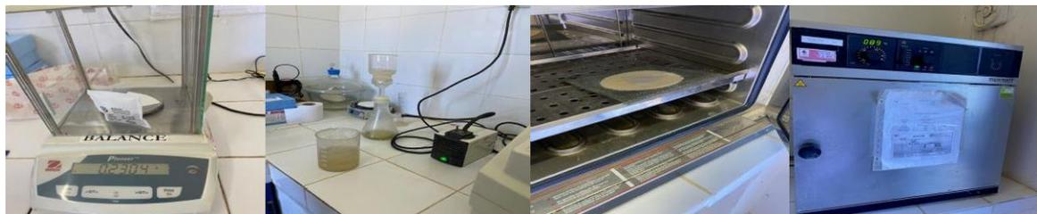
**Figure 2.18 :** Détermination des matières en suspension (MES).
