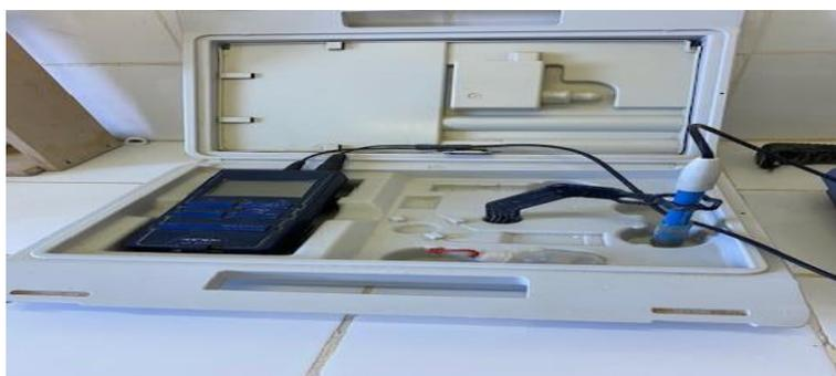
Figure 2.15 : Mesure du pH avec le pH-mètre.
