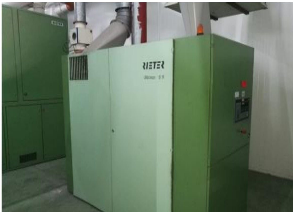
Figure II. 6 : Opération de n'nettoyage 'Uni Clean'.
