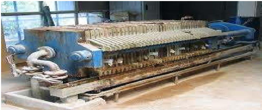
Figure (I.6) : filtration à presse.
