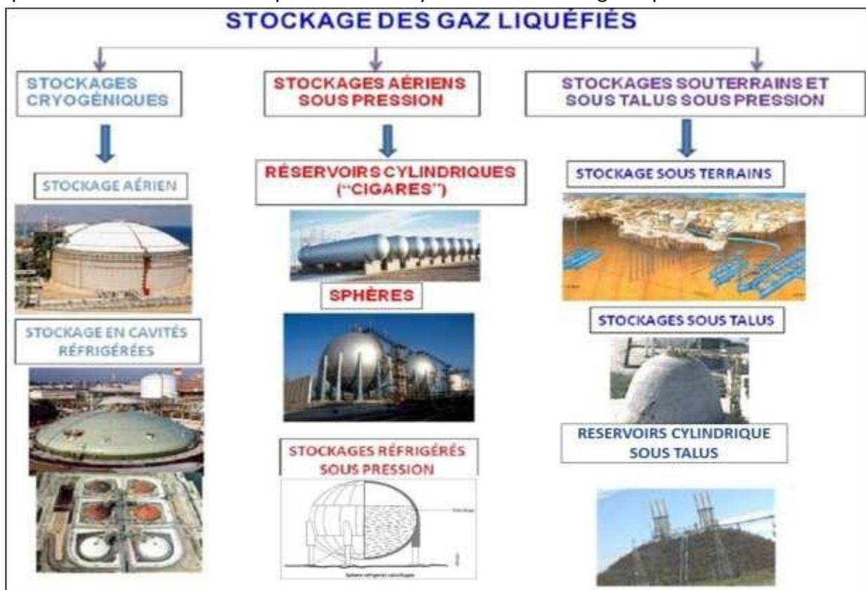
Figure 3.6: Types de stockage des gaz liquéfiés.
