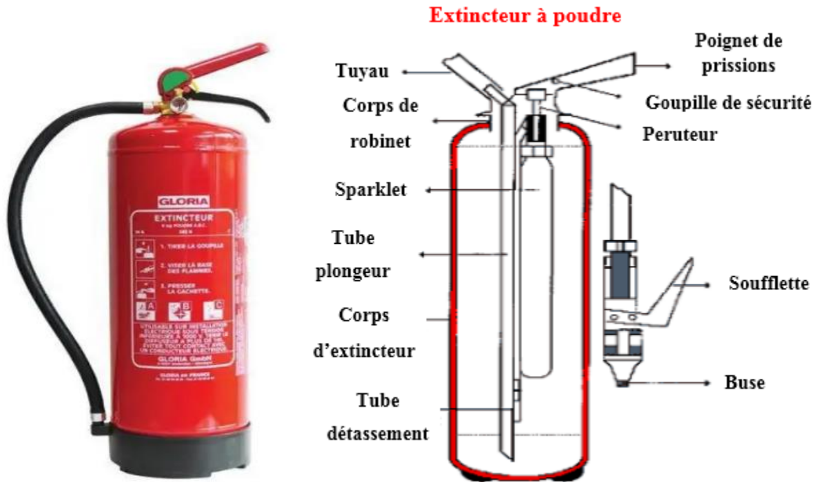
Figure 2.11 : Extincteurs à poudre [27]
