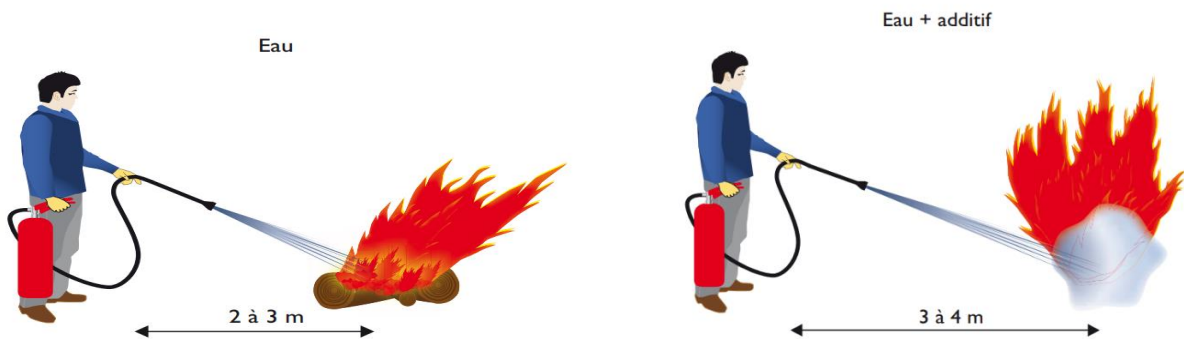
Figure 2.9 : Distances d'attaque pour les extincteurs à eau [2]
