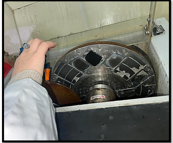
Fig : Amener la lame mince à la bonne épaisseur grâce à la rectifieuse
