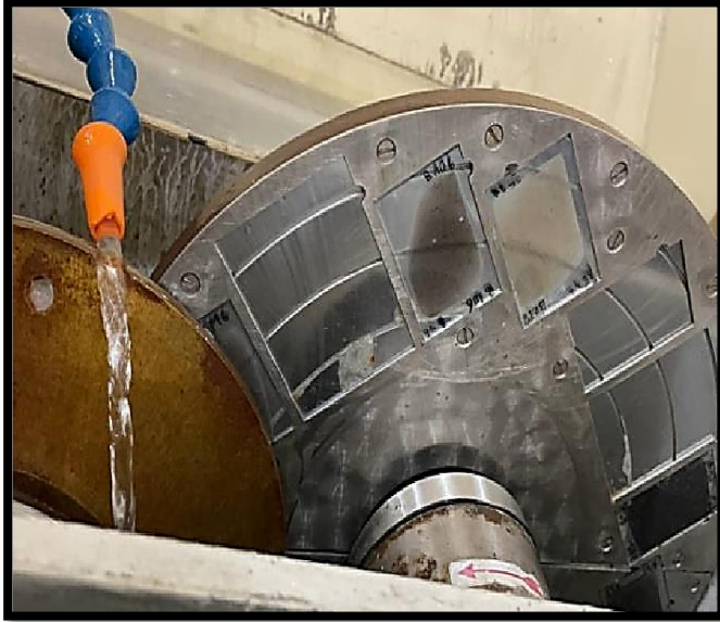
Fig : Passage de la lame dans rectifieuse
