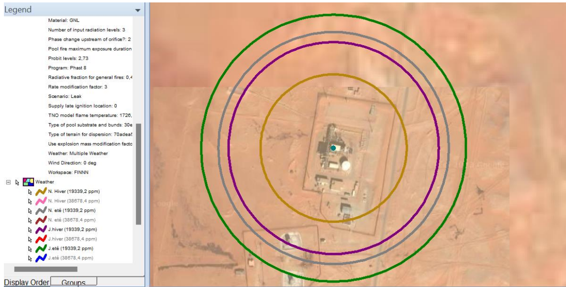
Figure IV. 32: Flash fire suite à une grande fuite
