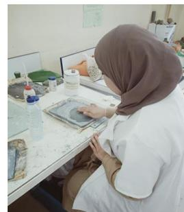
**Fig 10 : Finalisation du polissage de la lame**
