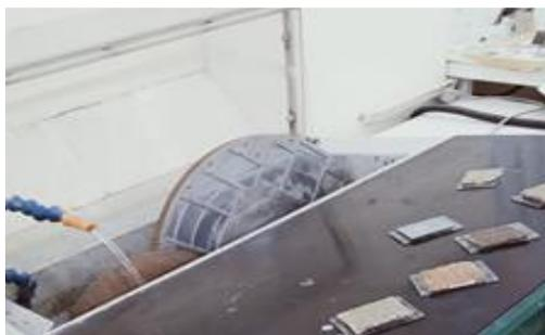
**Fig 9 : Amener la lame mince à la bonne épaisseur grâce à la rectifieuse**
