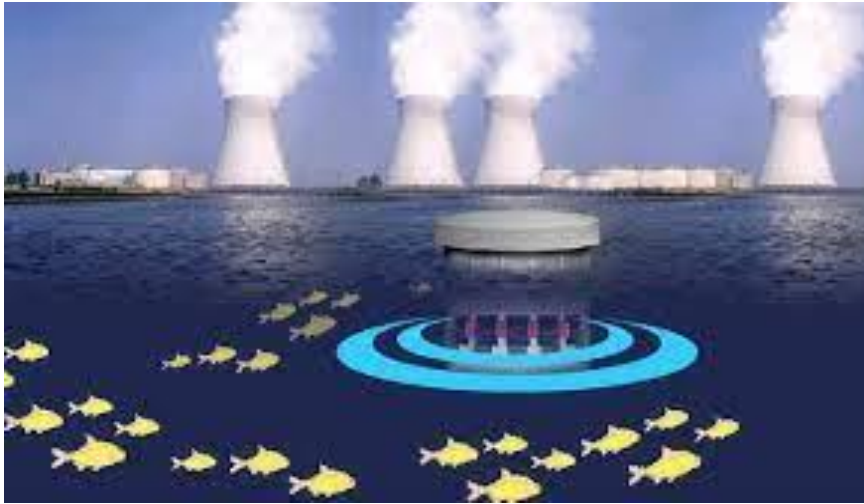
Fig. IV. 4 - Système des projecteurs sonores ( Sound array system ).
