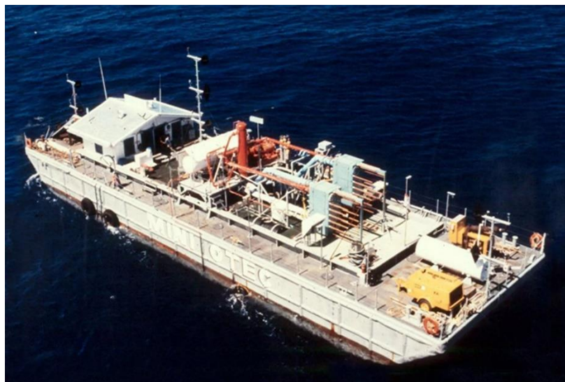
Fig I. 9 - Centrale océanothermique Mini-OTEC. (Expérimenté en 1979 à Hawaii).
