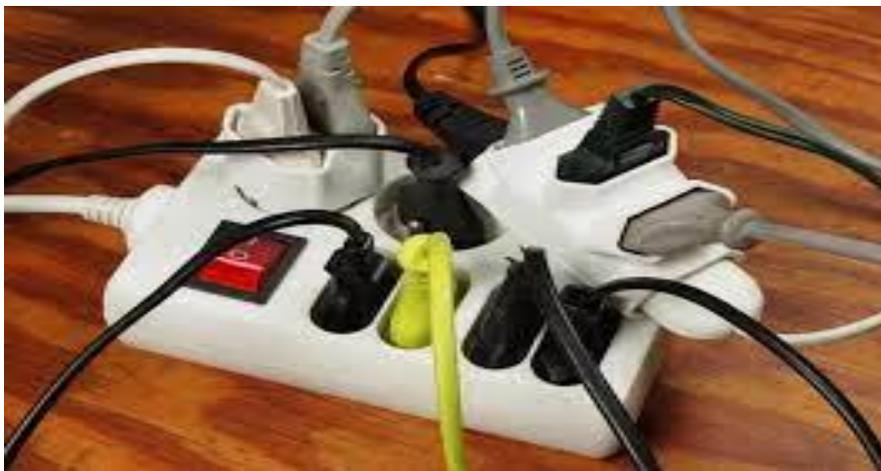
**Figure 2.6 : une surcharge électrique**
