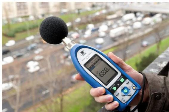
Figure 10 : sonomètre appareil de mesure du bruit
