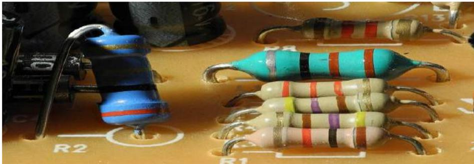
Figure I.5. Composants discrets (résistance).
