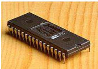
**Figure I.6. Circuit intégré (PROM) (transistor).**
