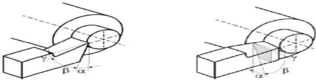
Figure 2.4 Angles du taillant (outil en travail)
