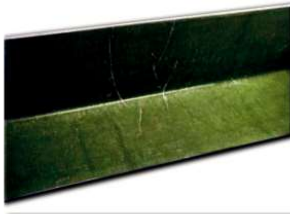
Figure II-11- Les rayures ou traces d'outil
