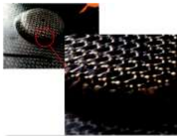
Figure II-16– Le manque de résine
