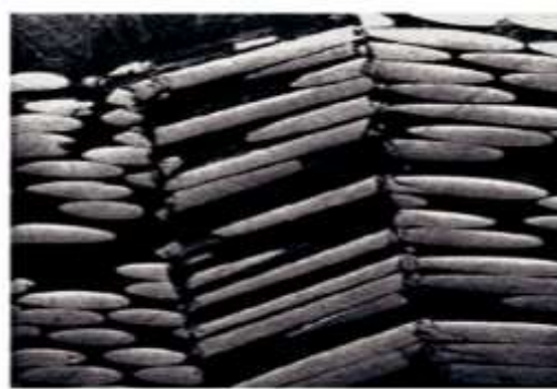
Figure II-2- Rupture fibre en compression[23]
