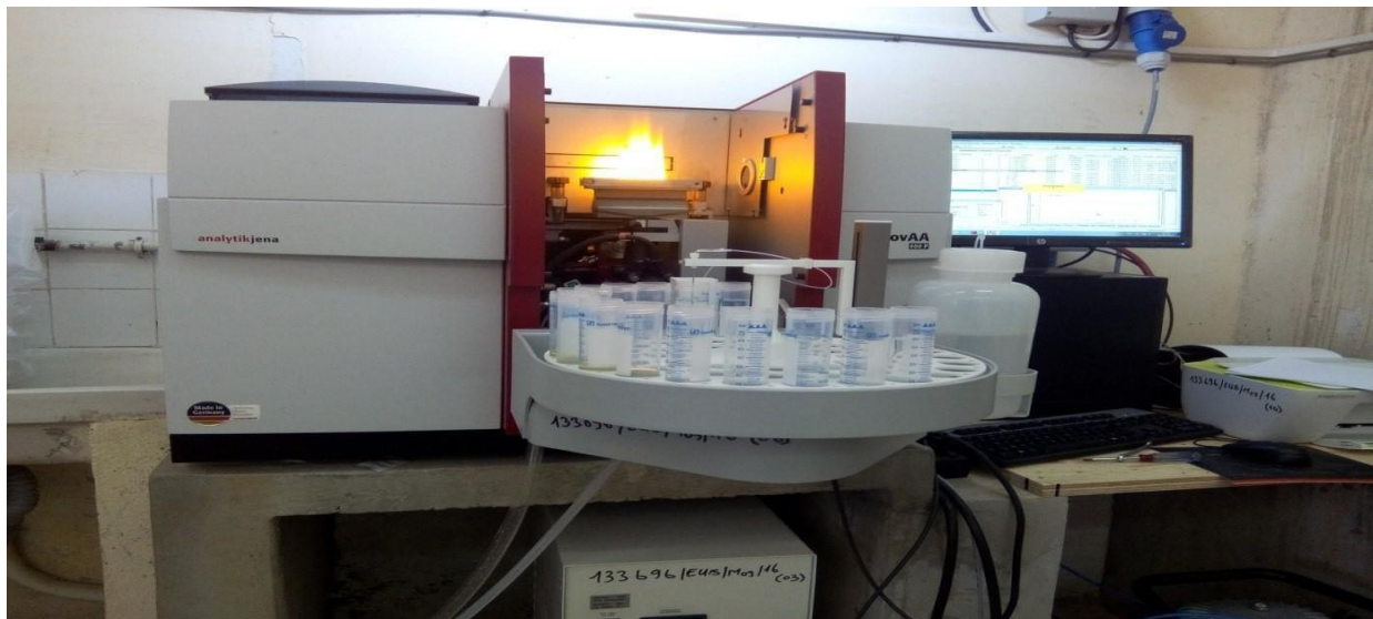
Figure II.16 : Spectrophotomètre d'absorption atomique ICE 3000 SERIES AA Spectromètre.
