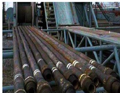
**Figure 11: Masses Tiges et Tiges de forage [26]**
