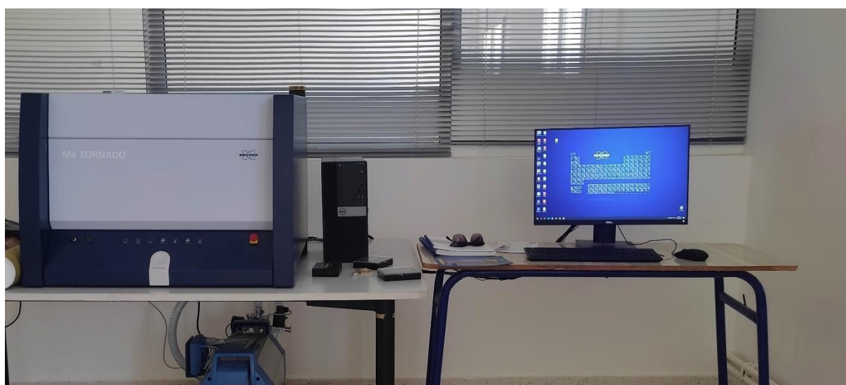
Figure III.11 : Spectromètre à Micro fluorescence X compact de type M4 TORNADO
