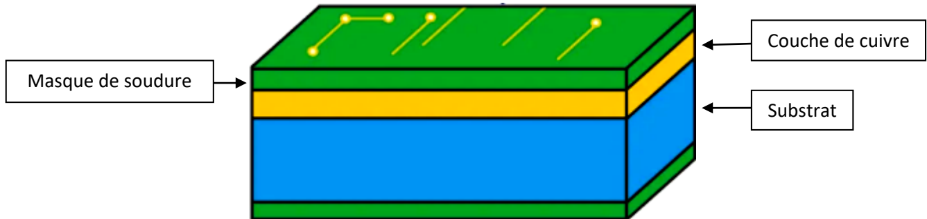
Figure I.5 : La structure du PCB simple face[18]
