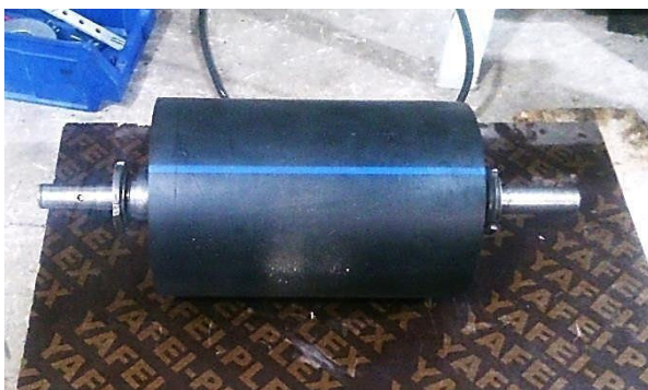
Figure III.6: Photographie tambour à aimants permanents logé dans un cylindre creux.
