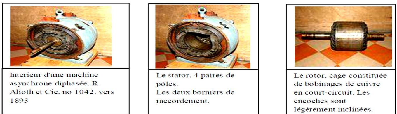
**Figure I.2.** Les éléments de la machine asynchrone
