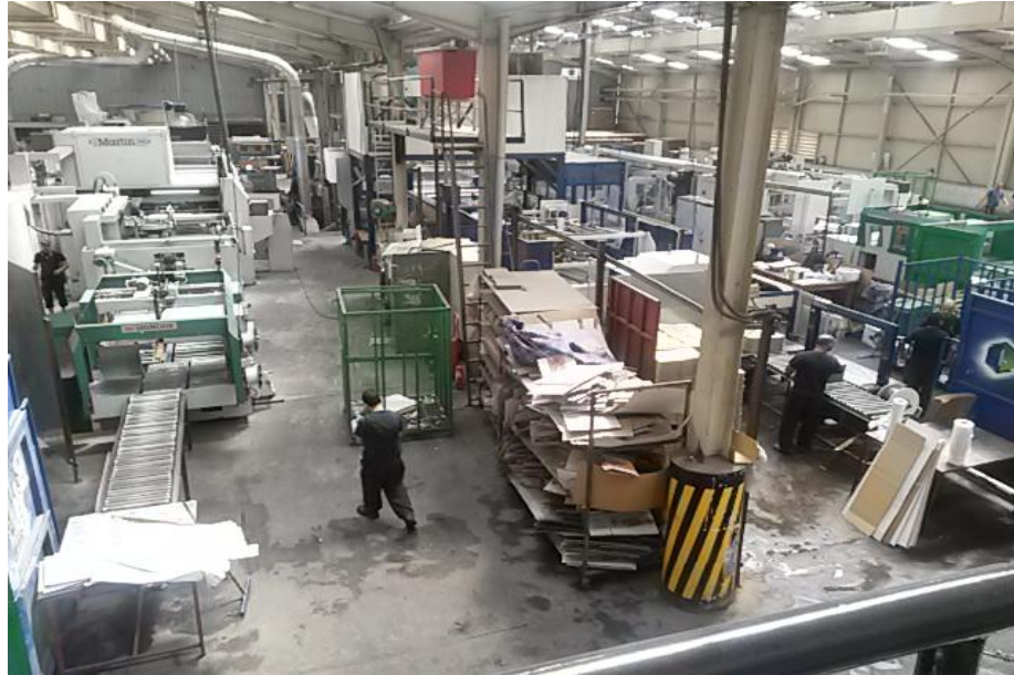
Figure IV.5 : Machines de transformation de carton (Case Maker)
