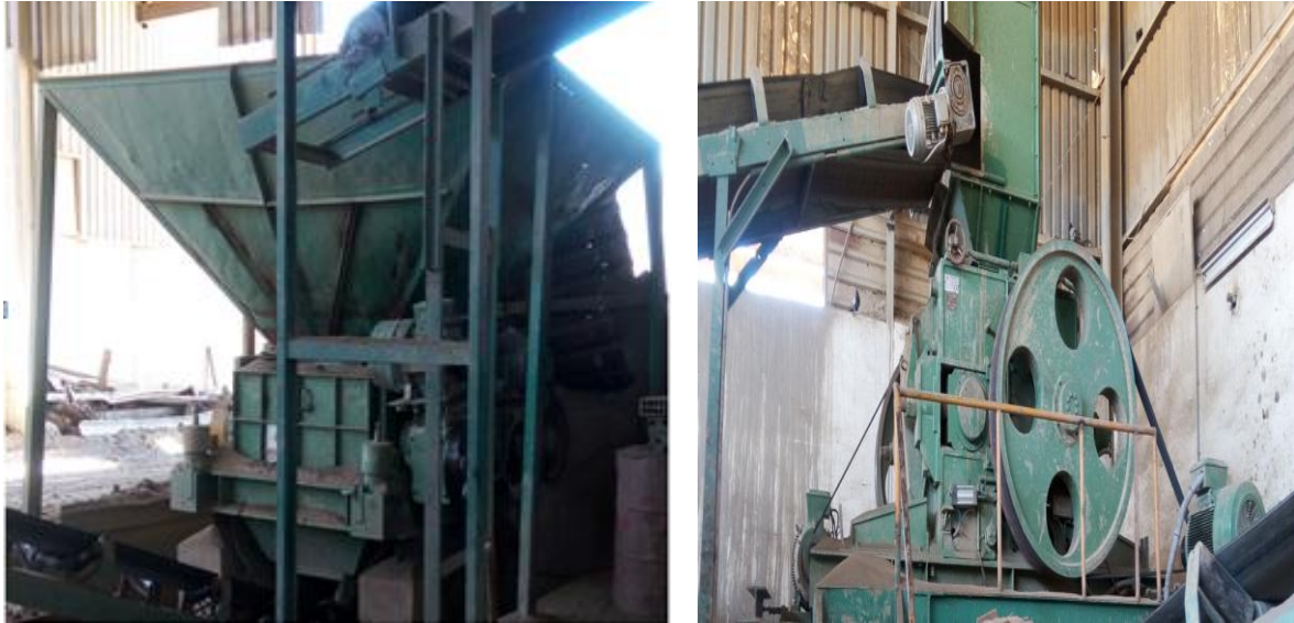
Figure 1.5 : Broyage et malaxage de l'argile .
