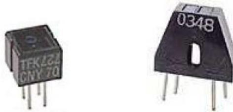
**Figure I.18 :** Opto-coupleur (une LED et un phototransistor)
