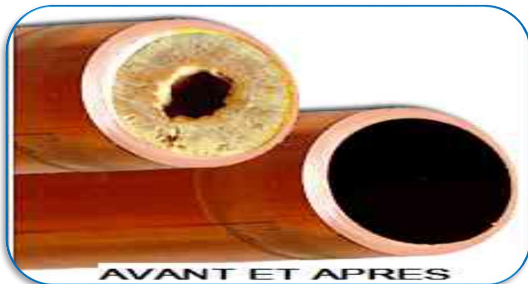
Figure. II.11: Représente un tuyau a été traité par détartreur électronique.
