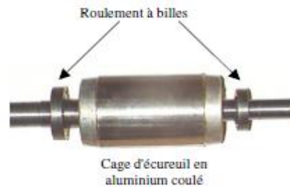
Figure.(I-3) : Le rotor à cage d'écureuil
